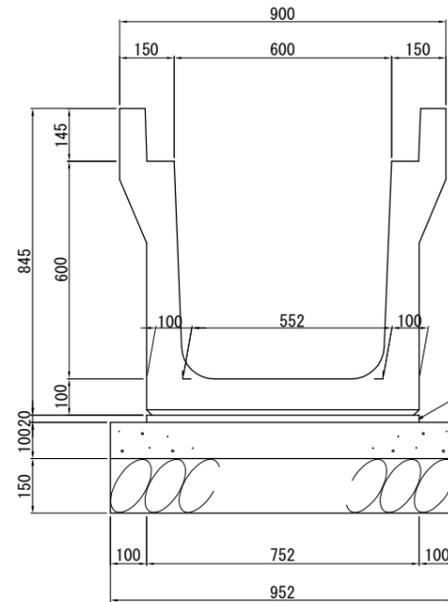
PU型側溝 グレーチング蓋 600×600 S=1:40
